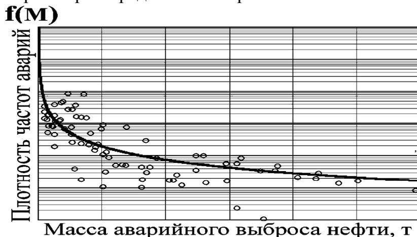
Рис.1.26. Регрессионная зависимость аварийных сбросов нефти в водоток при разгерметизации реального нефтепровода на подводном переходе реки
